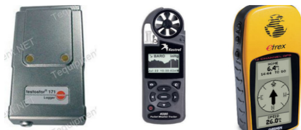
Зураг 5. Шатаах туршилтын үед орчны мэдээллийг авах багаж хэрэгсэл
