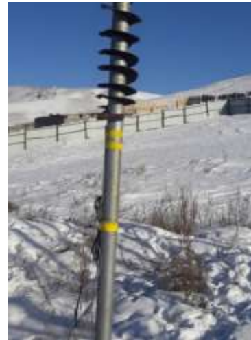
Зураг 2. Замын далан болон далангийн доод ул хөрсийг термосифон ашиглан хөлдөөх ерөнхий схем болон байгалийн нөхцөлд туршиж буй термосифон
