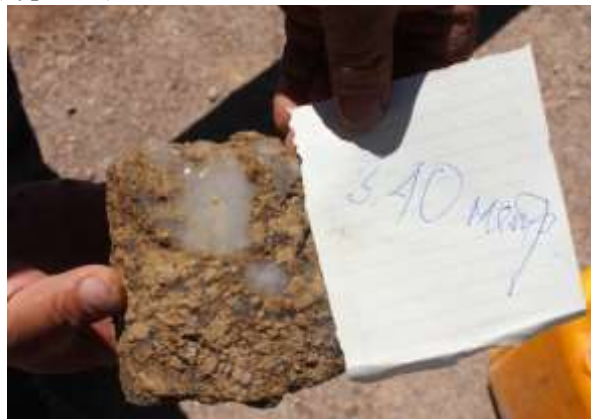
Зураг 11 . 17-р зүсэлт дээр өрөмдсөн цооногийн 3.4 м гүнээс илэрсэн мөсжилт ихтэй цэвдэг
