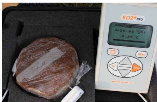
Фото 4. Хээрийн лабораторийн нөхцөлд ул хөрсний дулаан техникийн үзүүлэлтийг хэмжиж буй байдал.
