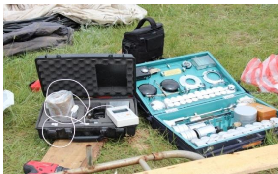
Фото 4. Хээрийн лабораторийн нөхцөлд ул хөрсний дулаан техникийн үзүүлэлтийг хэмжиж буй байдал.
