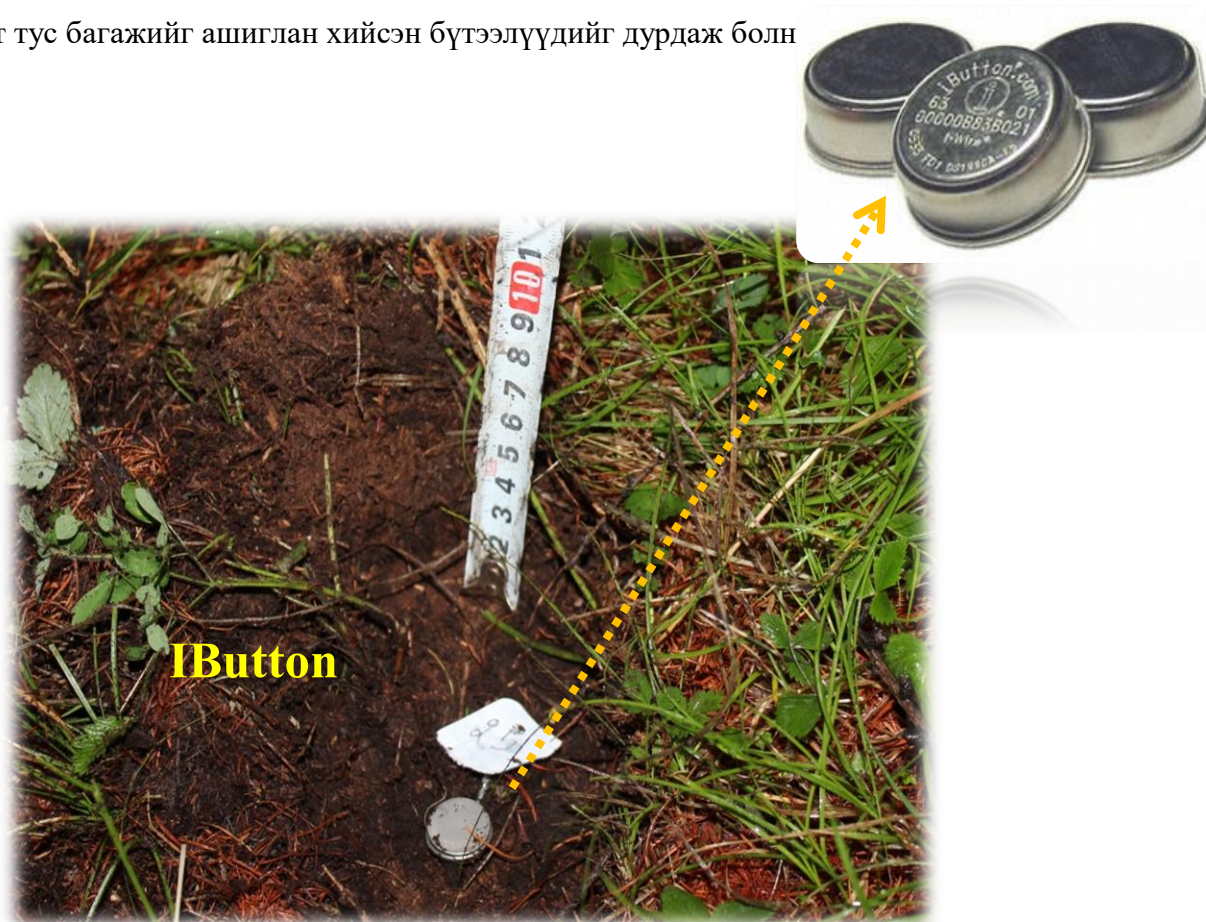
Зураг 7. Газрын гадаргын температур хэмжигч “ibutton”
